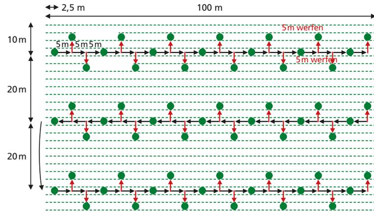
Schema: Manuelle Ausbringung TRICHOSAFE®-Kugel (125 Kugeln pro Hektar)
