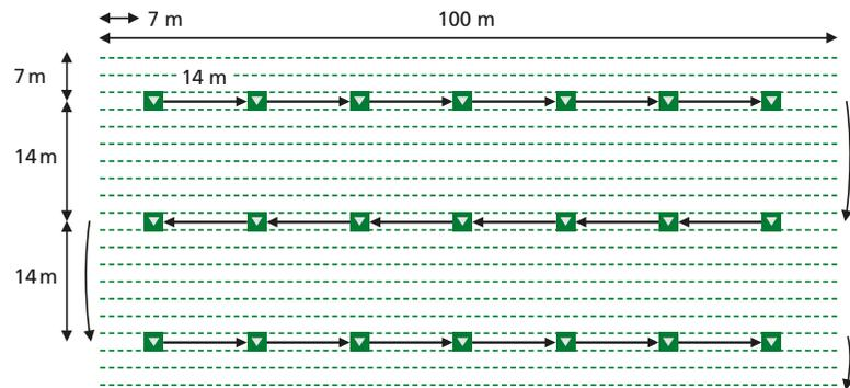
Schema: Manuelle Ausbringung TRICHOSAFE®-Anhänger bei schwachem Befall (30 Anhänger pro Hektar)
